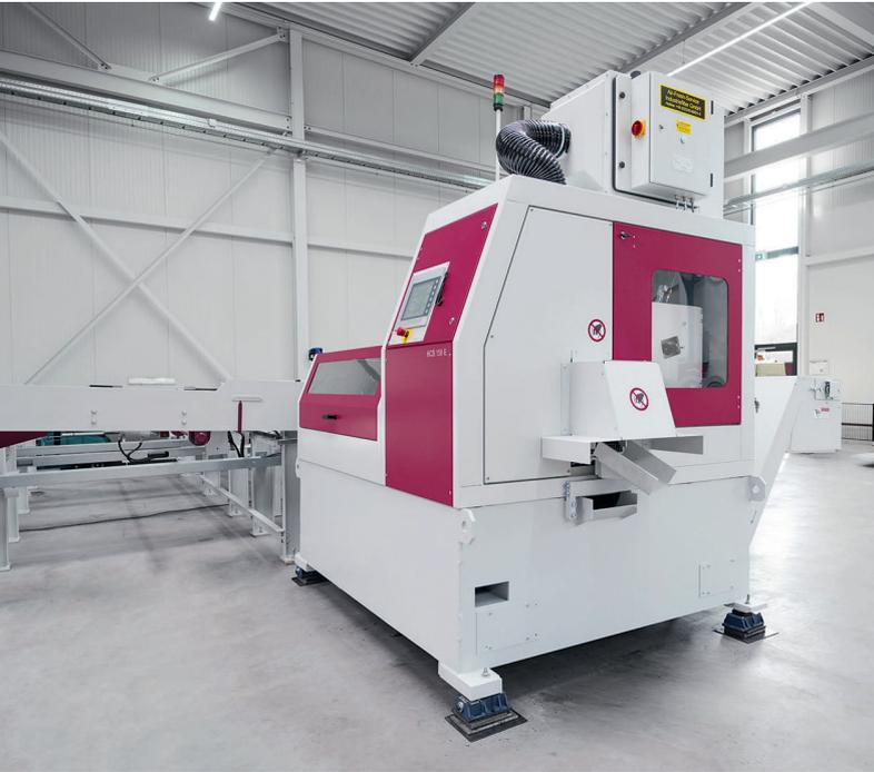
1 Den Einstieg in die automatisierte Produktion bietet die kompakte Hartmetall-Hochleistungskreissäge HCS 150 E © Behringer
